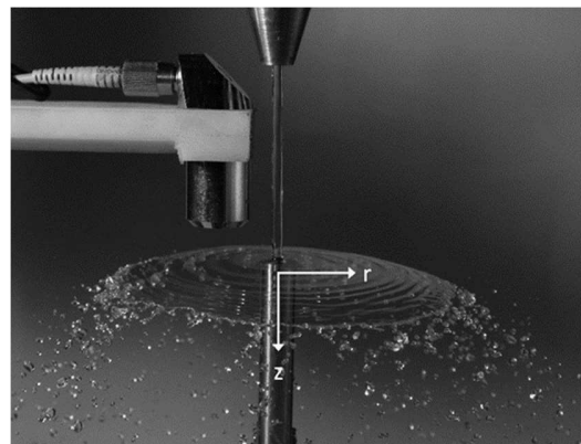
Abbildung 1. Links: Schematischer Aufbau zur Untersuchung freier radialer Flüssigkeitsfilme, die sich aus dem Aufprall auf einem vertikal oszillierenden Aufprallzylinder ergeben. Rechts: Photographische Aufnahme des erzeugten radialen Films mit beaufschlagten sinusförmigen Störungen (chromatisch konfokaler Messsensor oben links im Bild).
