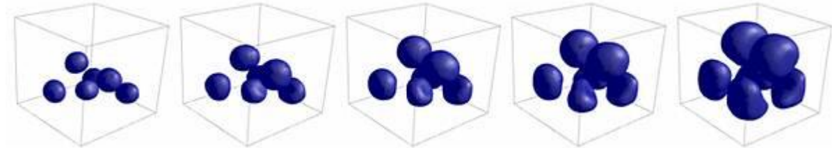
Abbildung 2: Exemplarisches Blasenwachstum unter Berücksichtigung der gegenseitigen Beeinflussung der Blasen
