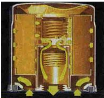
Abbildung 2 Ölfluss durch einen Ölfilter
